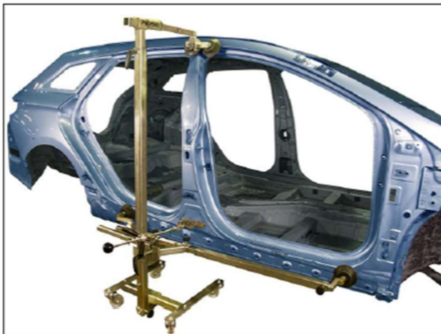
Richtvorgang am Seitenschweller
