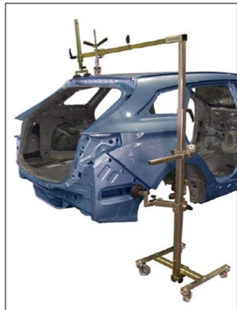
Richtvorgang an der Dachstruktur
